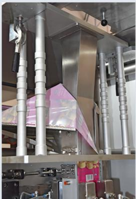
**TUBO FORMADOR ESPECIAL:** sistema antiatasco y enfriado interior para los productos que lo requieren.
