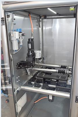
**SERVOACCIONAMIENTO:** Tanto el arrastre del film como la solda dura horizontal estan accionados por servomotor para garantizar mayor velocidad y mejor control.
